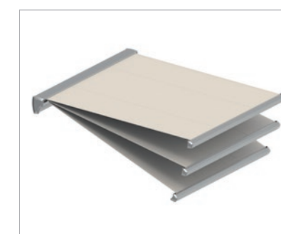
Uhol sklonu markízy VIVA 7040 je voliteľne nastaviteľný pomocou motora (Variotronic) alebo kľuky (Variomatic).
