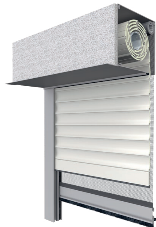
Predokenná roleta nova, štvorcová S nosičom omietky, z extrudovaného hliníka, voliteľne s ochrannou roletou proti hmyzu.
