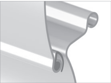
Prvotřídní uzavírání Oba profily lamel se uzavírají díky zabudovanému těsnicímu profilu velice tiše a propouštějí do místnosti méně světla.
