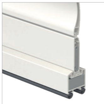
Zesílená koncová lišta Ocelová vložka znesnadňuje vylovení rolety páčidlem.
