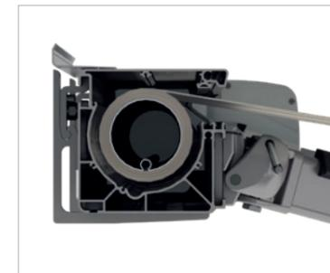
Besonders stabile Kassettenmarkise durch einteiliges Tuchkastenprofil und optimalen Wandanschluss.
