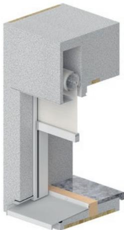
Textiler Sonnenschutz mit dem Fenster in die Fassade integriert.
